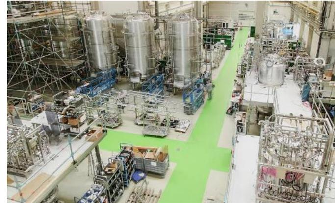
Standardisierte und effiziente Fertigung von Bioreaktor-Anlage zur Herstellung pharmazeutischer Wirkstoffe.
