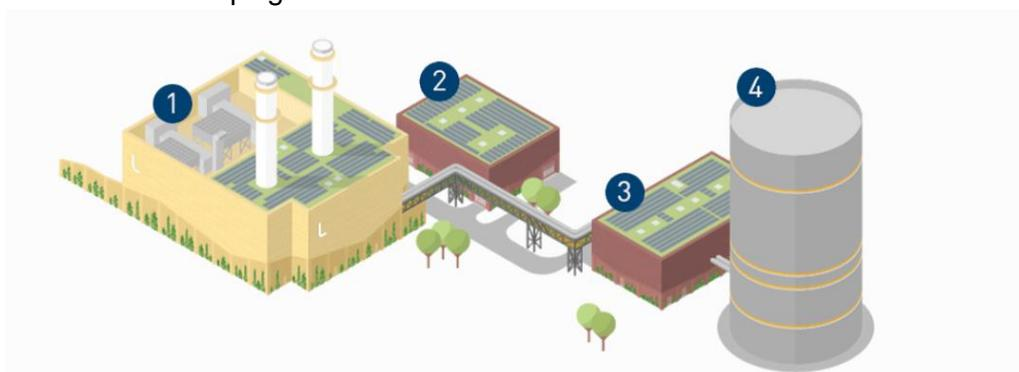
Das Heizkraftwerk Leipzig Süd besteht aus dem Kraftwerksgebäude (1), dem Versorgungsgebäude (2), der Pumpenhalle (3) und dem Fernwärmespeicher (4).
