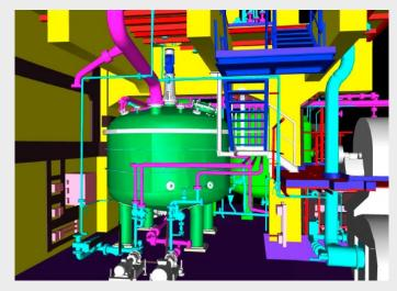
Das Eintragen und Aufstellen von Bauteilen in einen schwer zugänglichen Produktionsbereich können wir mittels 3D-Laserscan simulieren und Möglichkeiten des geringsten Aufwandes aufzeigen. Diese sind Grundlage für eine optimale Umsetzung Ihres Projektes. Die benötigte Dokumentation erstellen wir mit gängiger DV-Software um eine Weiterverarbeitung für Sie zu erleichtern.
